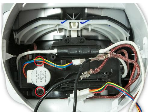
**94** Retire los dos tornillos T-10 que sujetan el motor del modo Flujo.
