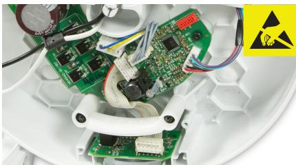
**25** Localice el botón de encendido en el ensamblaje de la pantalla LCD y la placa de circuito impreso (PCB).
