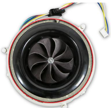
**137** Coloque el nuevo sello dentro de la ranura en el cubo del motor.
