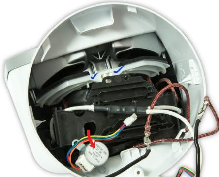
**96** Libere el motor del modo de flujo de la placa de cableado.
