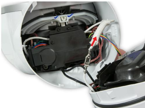
**70** Retire los cables neutros del soporte en el conjunto del cubo del motor. Deslice la funda de tela de vidrio lejos de los terminales neutros.
