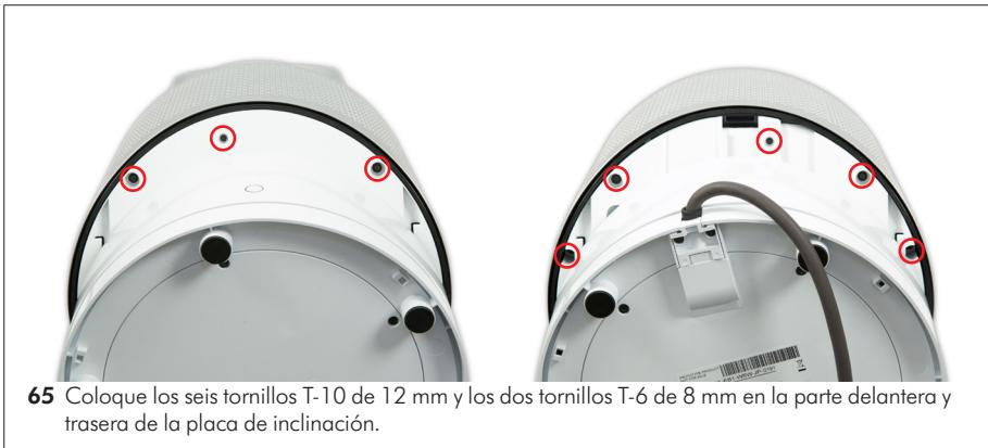
**65** Coloque los seis tornillos T-10 de 12 mm y los dos tornillos T-6 de 8 mm en la parte delantera y trasera de la placa de inclinación.
