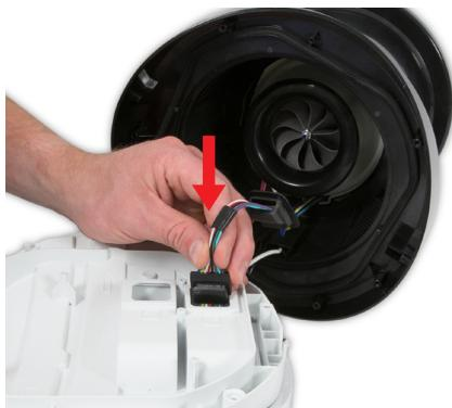
**144** Pase el mazo del motor a través de la placa de inclinación hasta la carcasa del cuerpo inferior.
