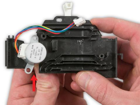
**106** Deslice el motor del modo de flujo en la placa de cableado como se muestra.
