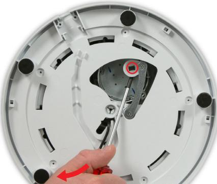
**07** Retire cuidadosamente el anillo de seguridad. Haga palanca en la leva de oscilación del motor de oscilación.
