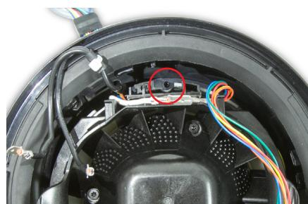
**143** Pase los mazos de cables a través del cuerpo principal. Asegúrese de que el motor y el conjunto del cubo estén alineados con los detalles en el estante del cuerpo principal.
