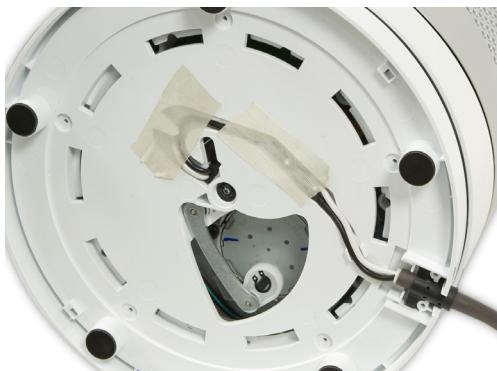
**32** Encaje los cables de fase y neutro en los retenedores proporcionados en la placa base.
