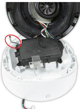
**125** Libere cuidadosamente el cable del sensor térmico.
