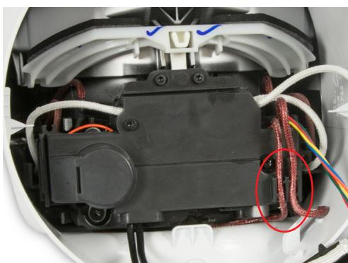
**116** Coloque con cuidado los cables en los retenedores de la cubierta del terminal.
