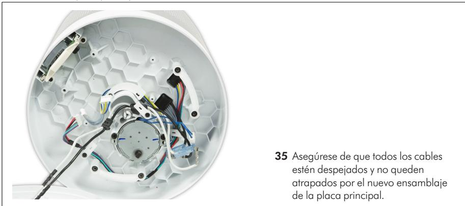
**35** Asegúrese de que todos los cables estén despejados y no queden atrapados por el nuevo ensamblaje de la placa principal.
