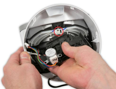
**107** Coloque el extremo del brazo de palanca del motor en el orificio del conjunto de servicio de la aleta de enfoque de flujo.
