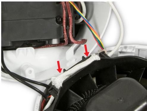
**84 Importante:** Coloque de forma segura la cinta de tela de vidrio en el soporte provisto.
