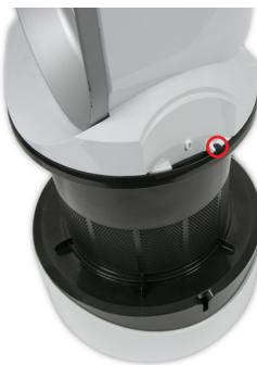
**87** Coloque los dos tornillos T-8 de 10 mm en cada lado del conjunto del amplificador.
