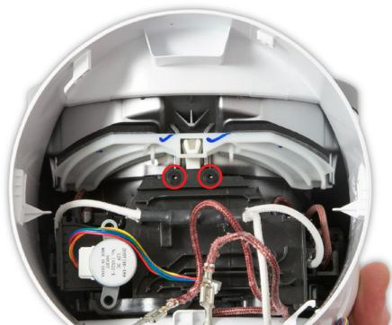
**109** Coloque los dos tornillos T-8 de 10 mm con arandelas captivas en la placa de cableado.
