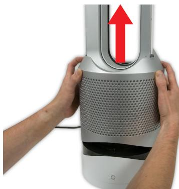
**89** Presione los botones de liberación a ambos lados del conjunto del filtro. Levante el conjunto del filtro sobre el conjunto AMP.
