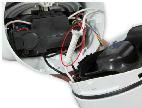
**83 Importante:** Coloque la funda de tela de vidrio completamente sobre las conexiones.
