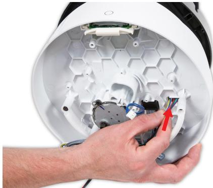
**132** Desde el interior de la carcasa inferior, empuje el pasacables del motor hacia afuera. Tire del mazo a través de la placa de inclinación.
