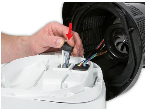
**147** Pase el mazo del amplificador principal a través de la placa de inclinación hasta la carcasa del cuerpo inferior.
