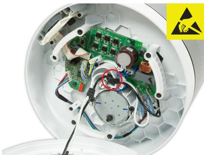
**46** Asegúrese de que el mazo de cables del motor de oscilación esté colocado correctamente.
