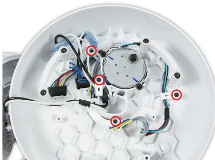
**121** Libere todos los cables de las abrazaderas en la carcasa del cuerpo inferior.
