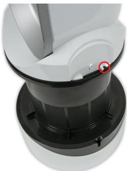
**118** Coloque los dos tornillos T-8 de 10 mm en cada lado del conjunto del amplificador.
