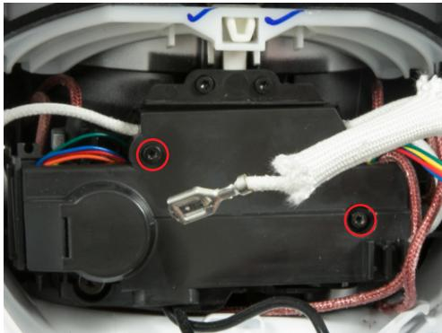
**72** Retire los dos tornillos T-8 en la cubierta.
