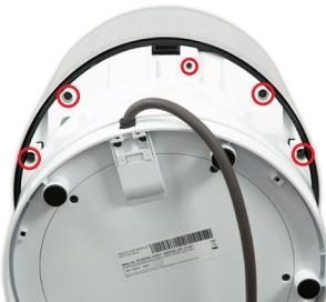
**48** Retire los seis tornillos T-10 de 12 mm y los dos tornillos T-6 de 8 mm de la parte delantera y trasera de la placa de inclinación.
