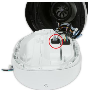
**149** Coloque de forma segura el cableado del amplificador principal más grande en la placa de inclinación.
