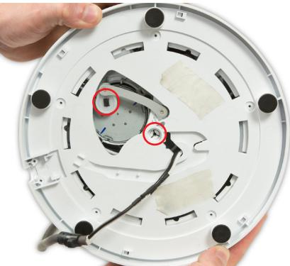
**27** Coloque la placa base en la carcasa del cuerpo inferior. Coloque la leva en el motor de oscilación. Coloque el centro de la placa base sobre el centro del soporte del tornillo.
