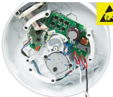
**45** Conecte los cables de fase y neutro a los terminales correspondientes de "piggyback".
