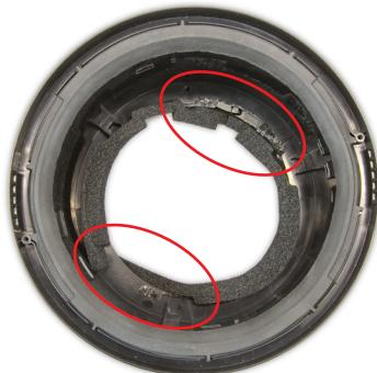
**135** Verifique que el sello de espuma del cubo del motor no presente daños. Si el sello de espuma del cubo del motor no necesita ser reemplazado, vaya al paso 133.
