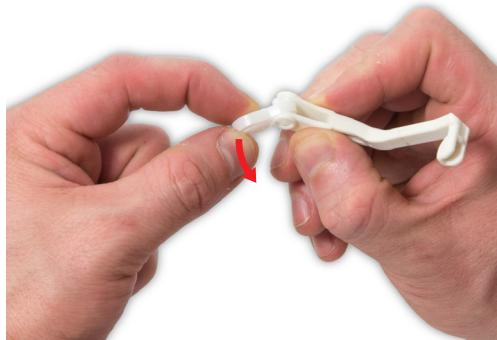
**99** Libere el brazo de enlace del brazo de palanca del motor.
