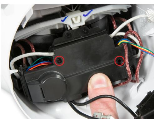
**80** Sujete firmemente la tapa mientras coloca los dos tornillos T-8.
