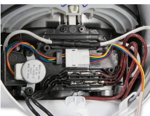
**113** **Importante:** asegúrese de que todos los cables estén colocados correctamente y alejados de cualquier área potencial de atrapamiento.
