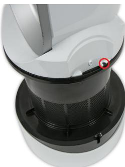
**90** Retire los dos tornillos T-8 de 10 mm de cada lado del conjunto AMP.
