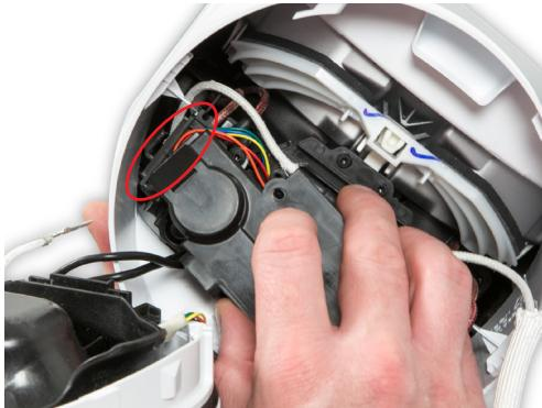
**114** Coloque con cuidado el borde de la cubierta en el espacio de la placa terminal.
