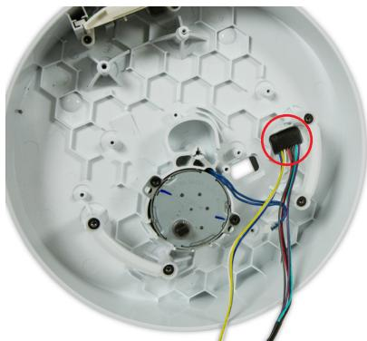
**145** Coloque el cableado del motor más pequeño de manera segura en la carcasa inferior del cuerpo.
