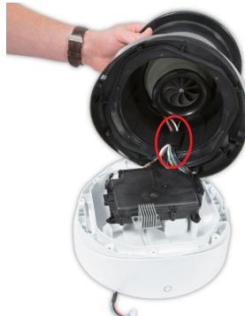
**124** Levante con cuidado la placa de inclinación y la carcasa inferior para separarlas del cuerpo principal.
