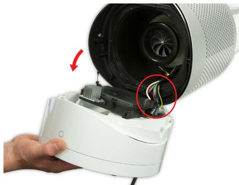
**49** Levante cuidadosamente la placa de inclinación y la carcasa del cuerpo inferior alejándolas del cuerpo principal.
