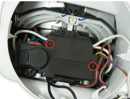
**92** Libere cuidadosamente los cables de la cubierta del terminal. Retire los dos tornillos T-8 en la cubierta del terminal. Levante la tapa.
