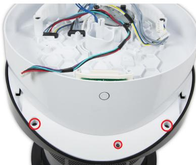
**123** Retire los seis tornillos T-10 de 12 mm y los dos tornillos T-6 de 8 mm de la parte delantera y trasera de la placa de inclinación.
