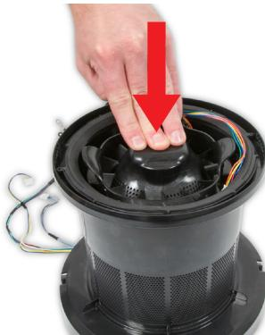
**141** Presione firmemente el conjunto del motor y el cubo en el cuerpo principal para asegurar que el sello esté firmemente adherido.
