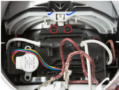
**95** Retire los dos tornillos T-8 con arandelas captivas que sujetan la placa de cableado al amplificador.
