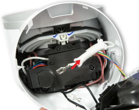
**81 Importante:** Deslice la funda de tela de vidrio sobre el lado del amperio del cable neutro.
