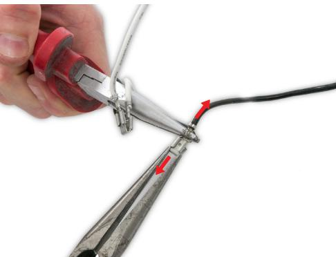
**22** Usando dos pares de alicates de punta larga, separe con mucho cuidado los cables de fase y neutro de los terminales "Piggyback".
