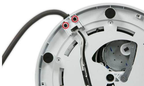
**04** Retire los dos tornillos T-8 de 10 mm.
