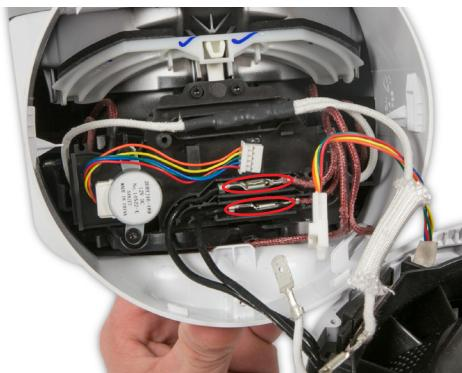
**74** Desconecte cuidadosamente los dos cables del calentador.
