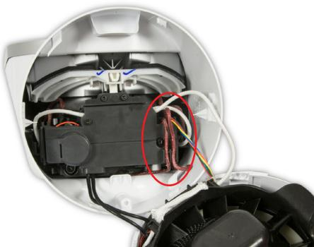
**69** Libere cuidadosamente los cables del retenedor en la cubierta.
