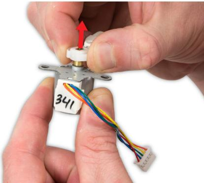
**98** Si la razón de la reparación es reemplazar el motor del modo de flujo o cualquiera de los componentes adjuntos a él, necesitará retirarlos. Extraiga el brazo de palanca del motor. Si el motivo de la reparación es reemplazar el conjunto de servicio de la aleta de enfoque de flujo, vaya al paso 100.
