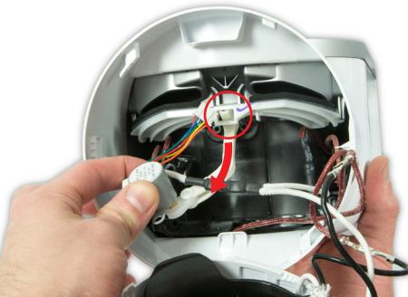
**97** Libere el brazo de palanca del motor del conjunto de servicio de la aleta de enfoque de flujo.
