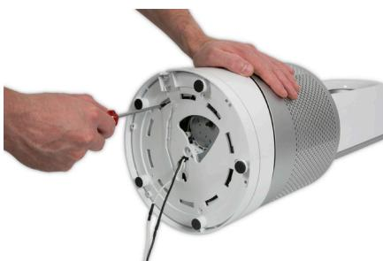
**09** Afloje los seis tornillos T-15 dando cinco vueltas completas (será necesario orientar la base para permitir el acceso a los tornillos).
